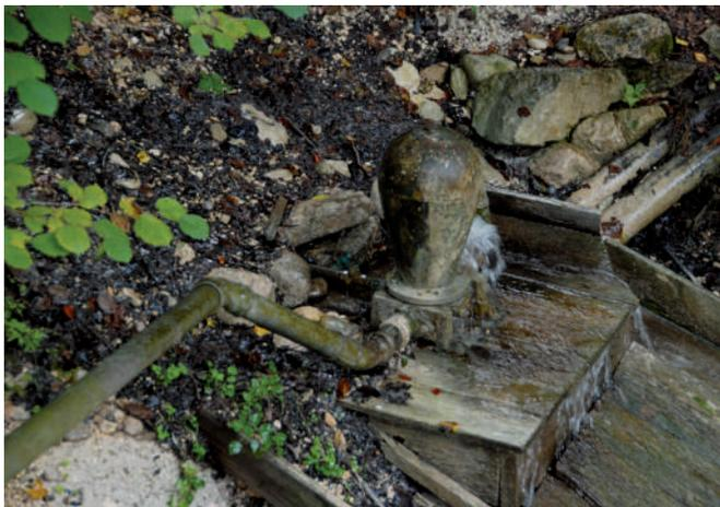
Abbildung 63: Hydraulischer Widder (© Stefan Hellebart)
