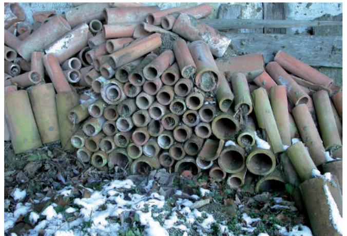
Abbildung 81: Früher wurden zur Dränagierung Tonrohre verwendet. (© Stefan Hellebart)
