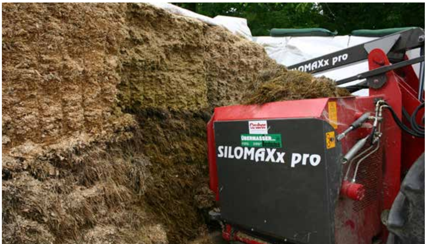
Abbildung 31: Bei kleineren Beständen können Entnahme und Verteilgeräte (z. B. Silokämme, Fräsverteilwägen) Zeit und körperliche Arbeit einsparen helfen. Foto LK NÖ
