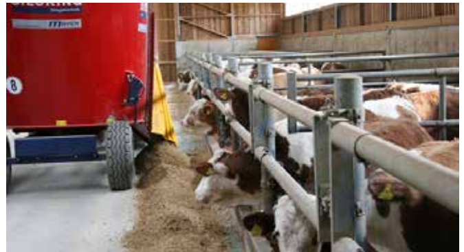
Abbildung 34: Futtermischwagen ermöglichen homogene Rationen, die Kosten sind höher als bei reiner Verteiltechnik. Foto LKNÖ
